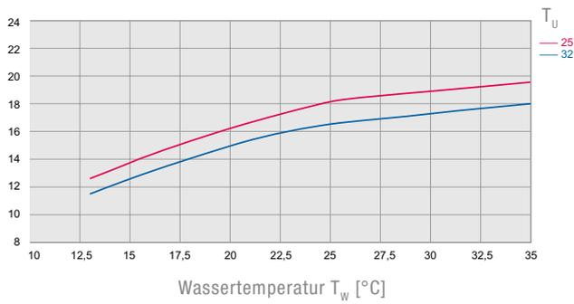
Die Leistungskennlinien beinhalten die Verluste der Standard-Pumpe und beziehen sich auf 50 Hz (Netzfrequenz) und eine 20 %ige Glykol-Mischung.
