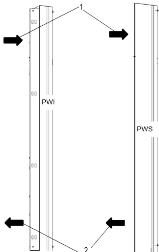
Immagine 1 - Vista laterale principio del fusso d'aria Scambiatore di calore aria/acqua PWI/PWS
