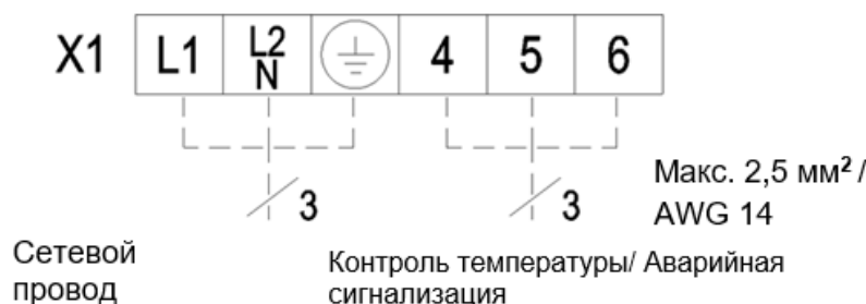
Рис. 15 – Электрическое подключение
